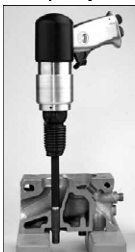
Manutenção de guias de válvulas
